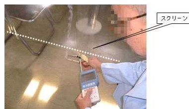
スクリーン下の空気の流れ 喫煙コーナーへむかう一定の気流(0.28m/s)があり、たばこの煙の漏れは認められない。
