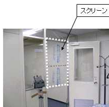
(ドア開放 + スクリーン) ドアを開放し、スクリーンで開口 面積を小さくすれば、煙の漏れ は認められない。
