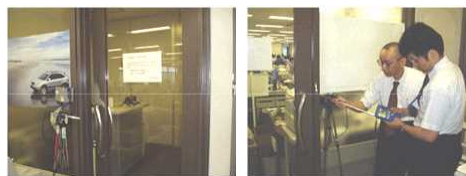
ドアストッパーでメークアップ・エアを確保、その流速は2m/s
