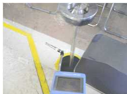
スクリーン下の空気の流れ 0.48m/sあり煙の漏れはない。
