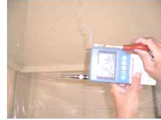
キャノピー部分の空気の流れ 上向き方向の気流0.19m/s
