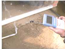
スクリーン下の空気の流れ 一定方向の気流(0.24m/s)がありタバコ煙の漏れはない
