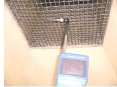
排気口における風速測定 排気風量実測値 (770m 3 /h)
