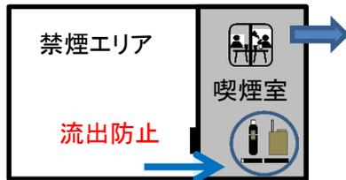
望まない受動喫煙を防ぐためには、喫煙専用室から屋内禁煙エリアへの煙の流出防止が必要
