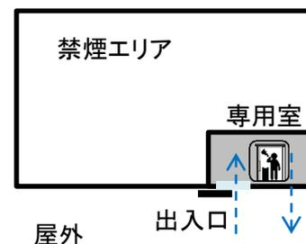
望まない受動喫煙を防ぐためには、喫煙専用室から屋内禁煙エリアへの煙の流出防止が必要
