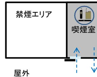
屋内禁煙エリアへは煙の流出が生じないため、煙の流出防止措置は不要
