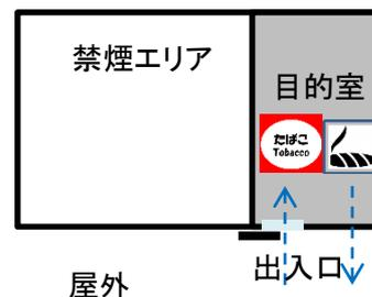
屋内禁煙エリアへは煙の流出が生じないため、煙の流出防止措置は不要
