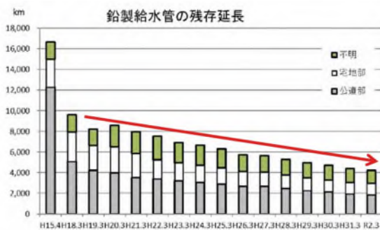
図 1 鉛製給水管の残存延長の推移
