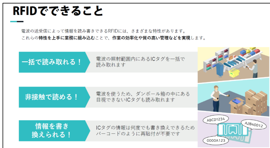
図 28. RF-ID の活用イメージ（複数の IC タグを離れた位置から一括で読み取り、瞬時に個体を識別することが可能。株式会社東北システムズ・サポート、「RFID とは？基礎知識編①RFID のイロハのイ」より許可を得て引用） 例えば、ダンボールに梱包された物品を箱の外側から読み取ることができ、検品や在庫チェックなどの作業効率がアップする。
