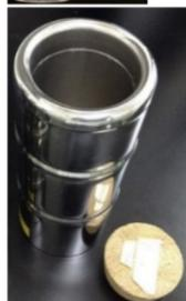
腫瘍・非腫瘍組織のバイアルを、液体窒素を容れたデュワー瓶（2重壁断熱容器）等を用いて浸漬し、急速凍結する。凍結には時間が必要であり、冷凍庫に移動する場合は少なくとも 5 分以上浸漬する。
