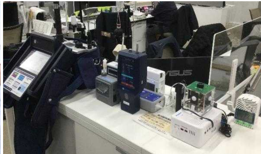
測定技術者による法定空気環境測定（左）、研究者の立入調査とセンサー（中）、自動計測センサー類（右）
