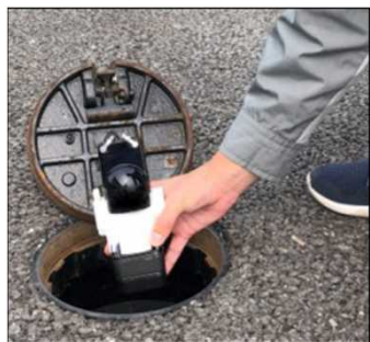
振動センサーを活用した水道管の漏水検知システム
