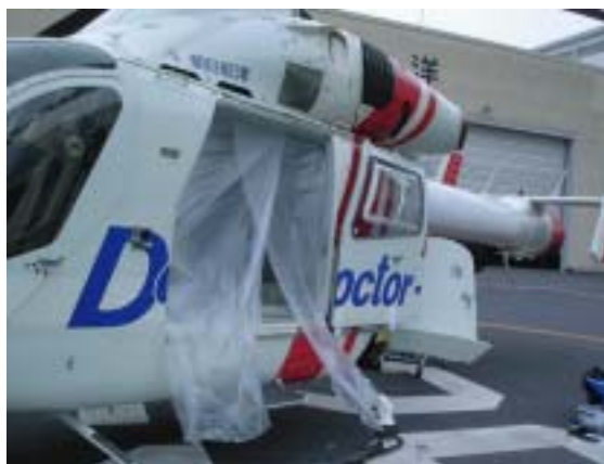
図 ヘリコプター内部（内壁）のビニールを貼付し 防護した外側から見た状況（扉を開いた状態）
