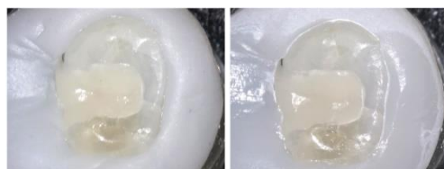
CAD/CAMインレー装着初期 ※ネクストビジョン（ヨシダより貸出）で撮影 歯ブラシ摩耗試験5万回後
