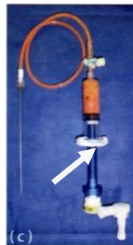
注入シリンジで注入
