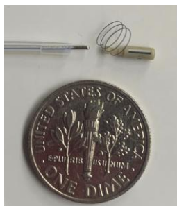
RFIDマーカ―/超小型無線発信器 (径1.8mm× 7 mm) 気管支鏡により肺癌病変の近くへ留置する
