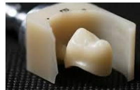
設計に基づき削り出し（CAM）
