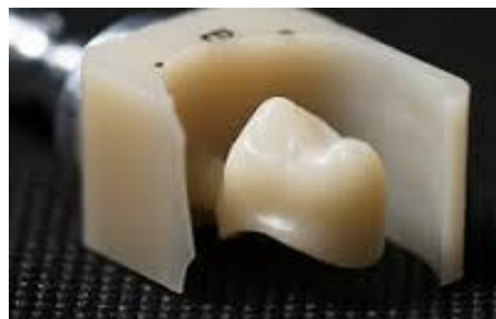
設計に基づき削り出し (CAM)
