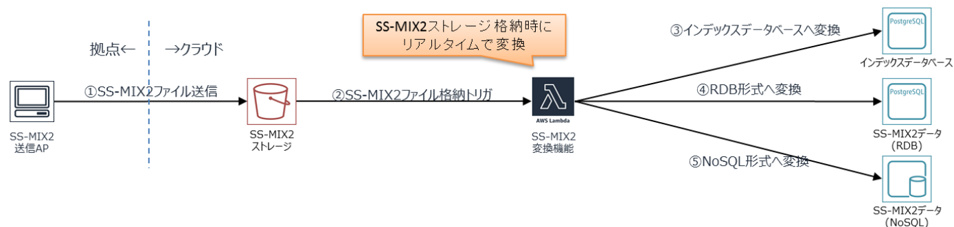
図 27 SS-MIX2 データを RDB、NoSQL に変換する方式
