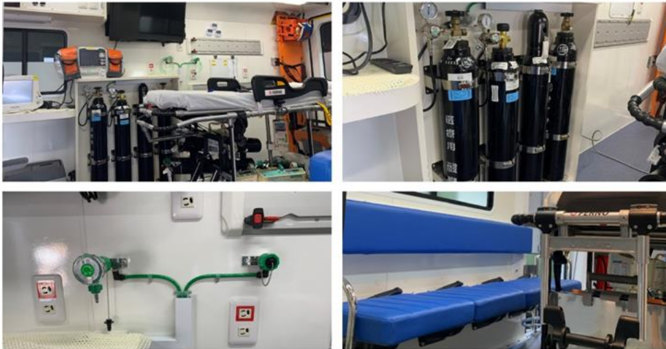
写真 1-5 車内（左上から、車内活動スペース、酸素ボンベ 10L 型（1500L）4 本、異なる酸素供給配管、5 名着席可能な座椅子）
