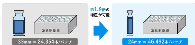
※バイアルの直径が小さくなったものの高さに大きな変更はなかったため、冷凍乾燥棚は既存設備の使用が可能。(内容物の容積は同じ)
