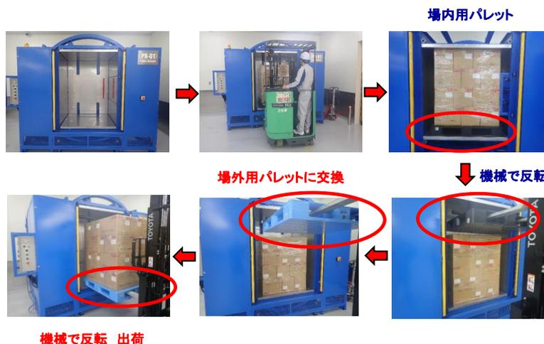
工場内パレットから屋外（出荷用）パレットへの製品積み替え
