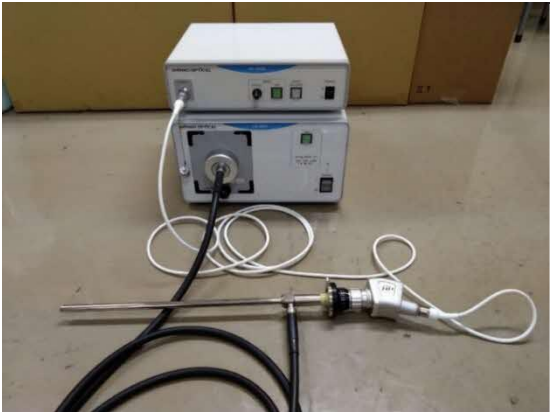
(図 1) IR-700 用内視鏡システム
