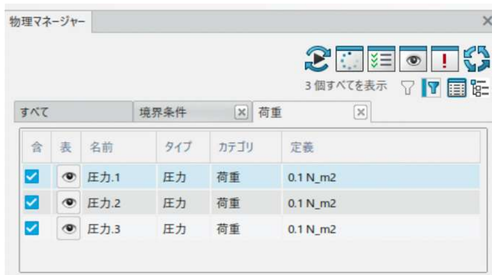
図 7 荷重条件の設定
