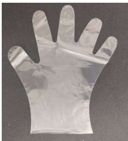
図2 製品 b: A 社 厚さ 35μm
