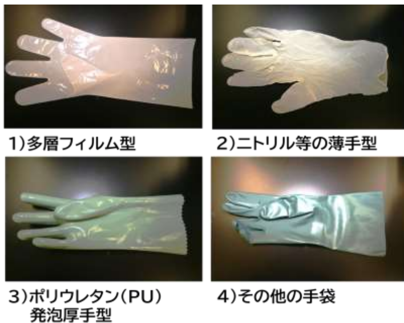
図2 計測した化学防護手袋の形状ごとの分類
