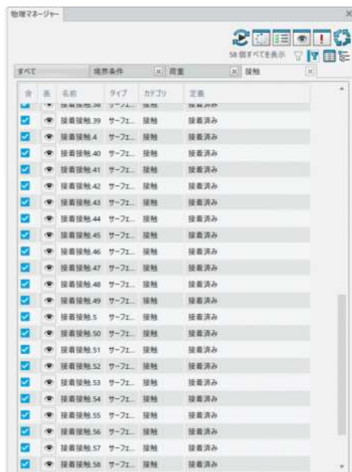
図 8 境界条件（接触条件）の設定
