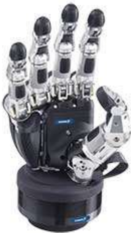
図1 5爪サーボ電動グリップハンド (SCHUNK : https://schunkjapan.jp/ )
