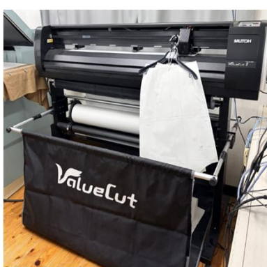
VC2-A100Q・MUTOH製 (プロッタ:プリンター+カッター)
