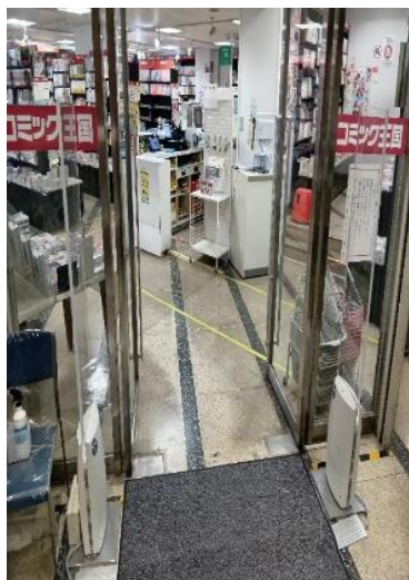
伊勢佐木町本店に設置した防犯ゲート
