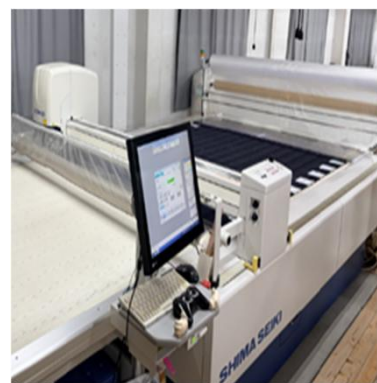
P-CAM161・SHIMA SEIKI製(積層式自動裁断機)
