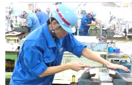
↑やすり掛け（ロッド製作）
