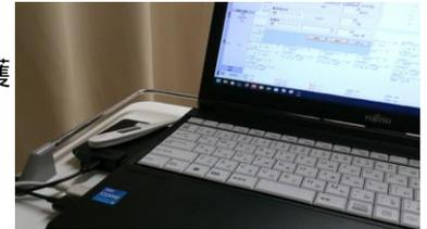
▲バイタルサイン測定の専用機器をICカードリーダーにタッチし電子カルテに反映
