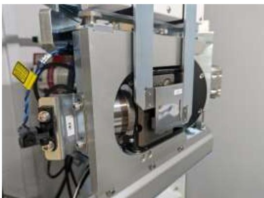
図3 大型 X線 CT 装置 TXS-34500FD HS に Cu0.1mm フィルターを付加
