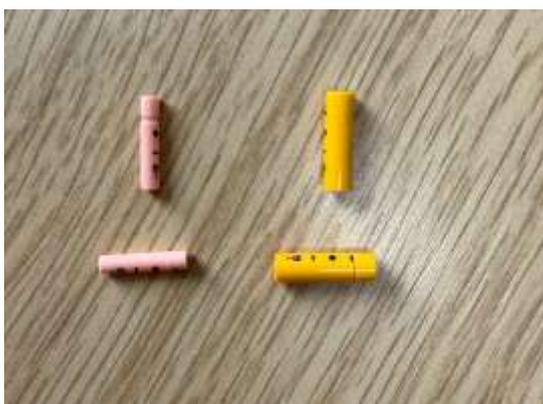
図2 ガラス線量計 GD302M (左) 及び GD-352M (右) の外観
