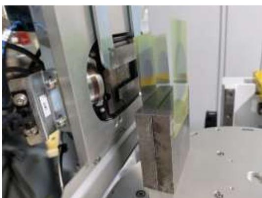
図 1 2 照射され、着色したガフクロミックフィルム EBT-4
