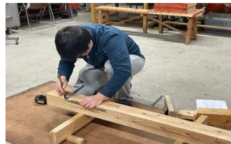
墨付け作業から学びます
