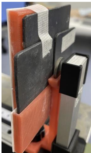
図 4. 鉛板による遮蔽の様子
