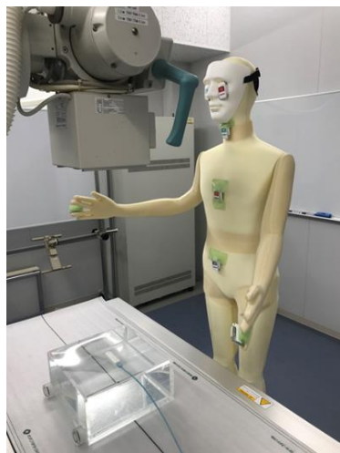
Fig 8. システムによる線量推定精度の検証における実験の配置
