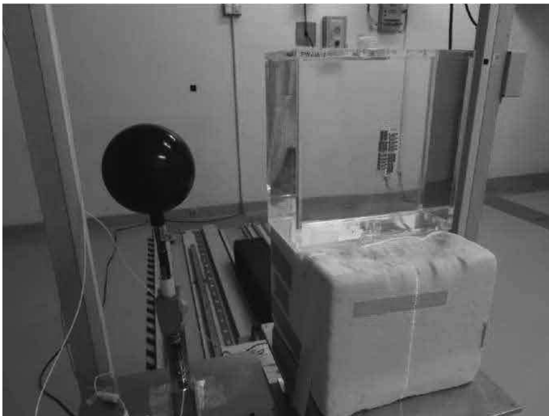
図2 本研究班で使用するガラス線量計 GD352M のエネルギー応答特性試験の様子。電離箱式空気カーマ率計（写真左）の隣がアクリル製 ISO-PW ファントムであり、アクリル樹脂製水槽の中央にガラス線量計を取り付けて照射試験を行った。
