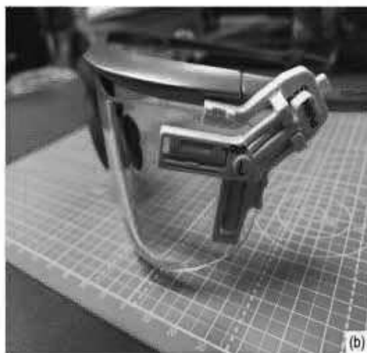
図 2 眼の水晶体線量計装着位置. (a) 装着位置 (上方)、(b) 装着位置 (側方)
