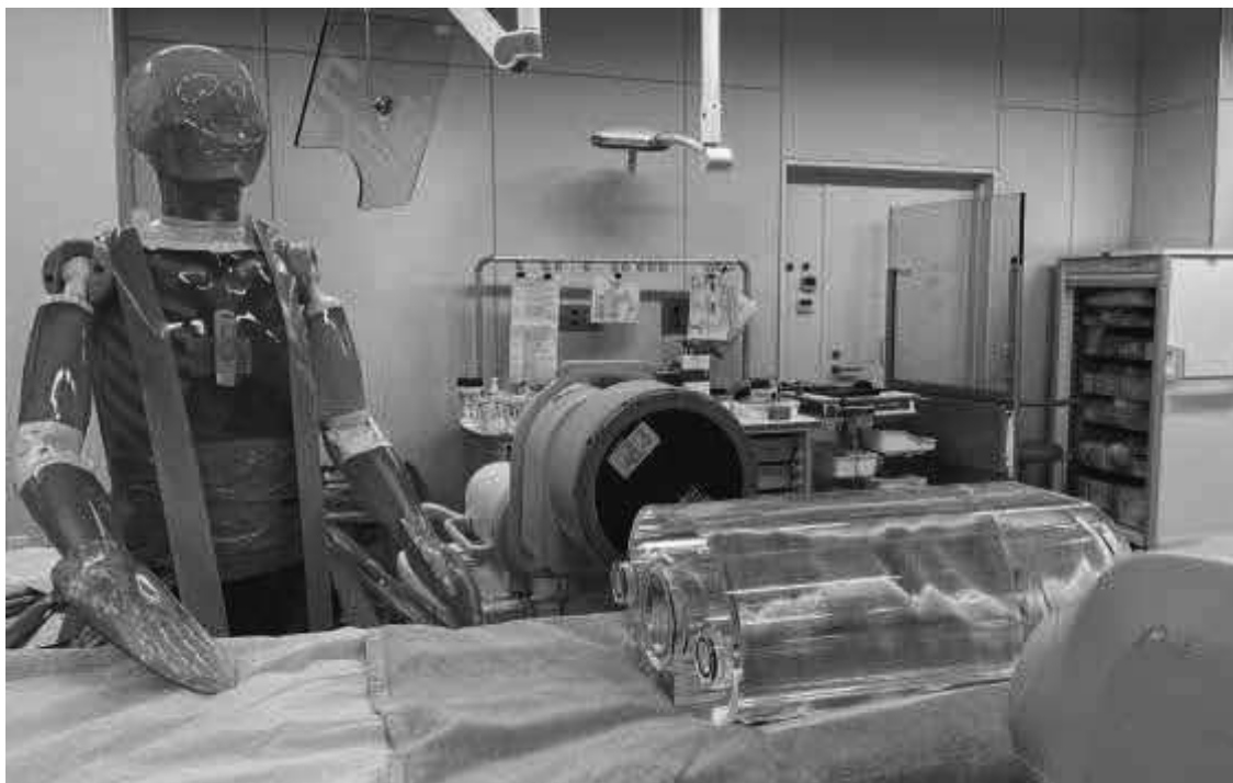
図3 本研究班で使用する小型ガラス線量計GD352Mをファントム各所に取り付けた予備試験の様子。
