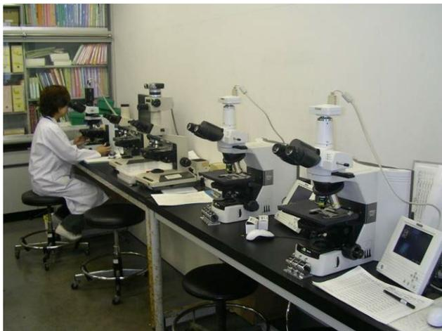
図 3.36 位相差・分散顕微鏡
