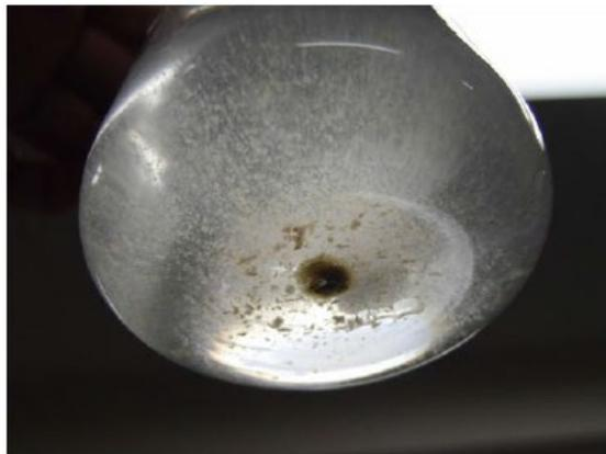
図 3.49 回転させるように攪拌すると底部に骨材のような重い成分が集まる
