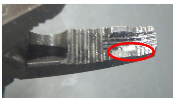
ペンチで採取すると、凹凸に石綿が付着するため、十分に洗浄してから次の試料を採取
