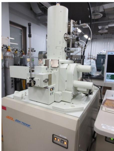
図 3.60 走査型電子顕微鏡 (SEM)
