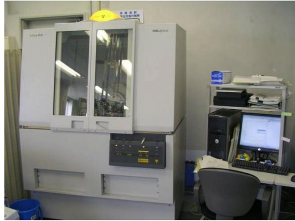
図 3.33 X線回折装置
