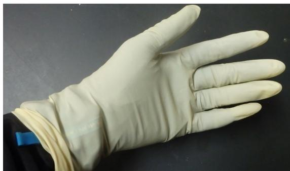
作業用の手袋は石綿が付着すると汚染の原因となる。ディスポ手袋を上にして、試料採取ごとに交換する。
