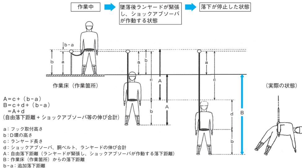
図2 胴ベルト型の落下距離等
