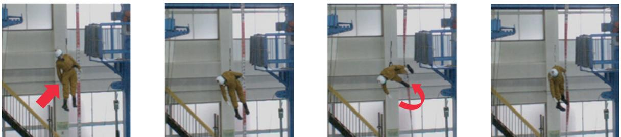
図4-12 胴ベルト型の人体ダミーの挙動
