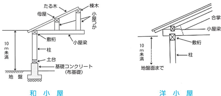
図2-10 ガイドラインが適用される工事例
