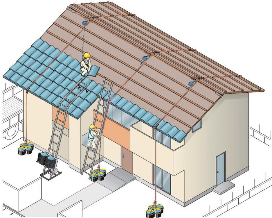
図2-39 屋根上の墜落・転落対策設置 (例)
