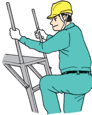
注意) (一社) 仮設工業会の認定では高さ1.5mを超えるアルミニウム合金製可搬式作業台に手がかかり棒の設置を義務付けている。
