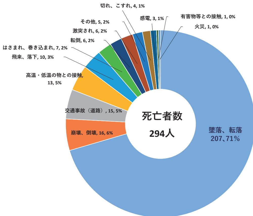
図1-2 木建工事における労働災害（死亡）の事故の型別発生状況
