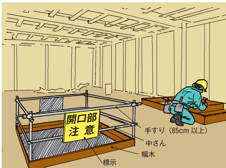
図2-19 開口部周りの墜落防止措置の例
