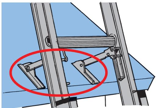
図3-6 屋根用補助金具で安定させる一例
