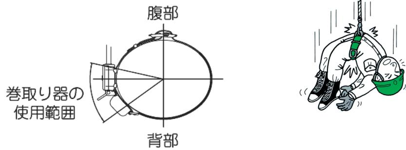
図4-17 胴ベルト型の装着説明図
