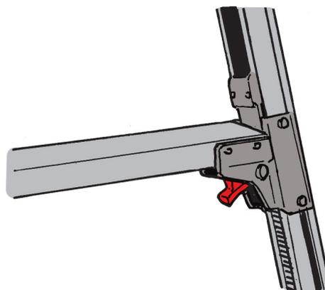
図3-20 伸縮脚のロック機構の例
