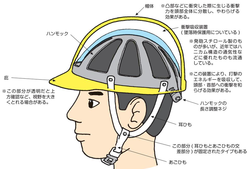
図4-20 保護帽の基本構造(あごひもが耳ひもに固定されたものの例)
