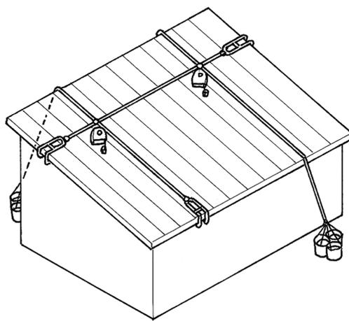
図2-35 片流れ屋根の親綱等設置の例
