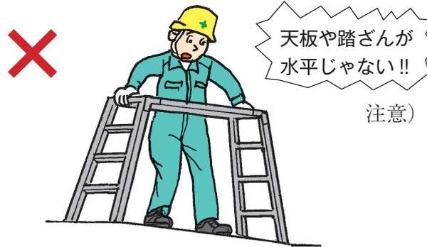
注意) アルミニウム合金製可搬式作業台は脚が伸縮するものが多い、同機能を利用して天板を水平にする。
