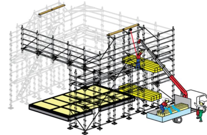
図2-33 スライドレール式安全ブロック工法を用いた作業方法の一例 (株)東京 BK 足場
