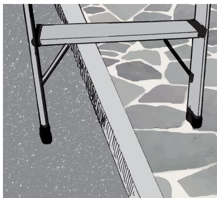
注意) 脚が伸縮する脚立は、わずかな傾斜地や段差では天板を水平に維持するため脚の長さ調節を行う。また、やむを得ず軟弱地盤上への設置が必要な場合は、敷板等により脚の沈下防止を図る。
