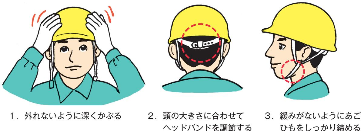
図4-21 保護帽の正しい着用方法の確認の仕方
