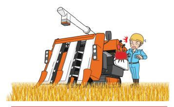
《災害事例》 機械を停止することなく、ワラ等を取り除く清掃作業を行い、コンバインの駆動部分に右腕を巻き込まれる
