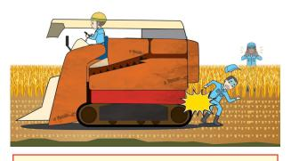
《災害事例》 収穫の位置変えのためコン バインを後退したところ、補助者に激し く当たる
