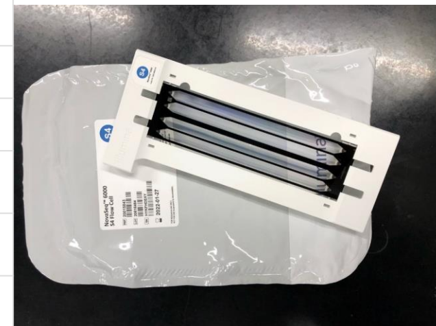
S4フローセル : ヒトがん全ゲノム解析に主として用いられる
