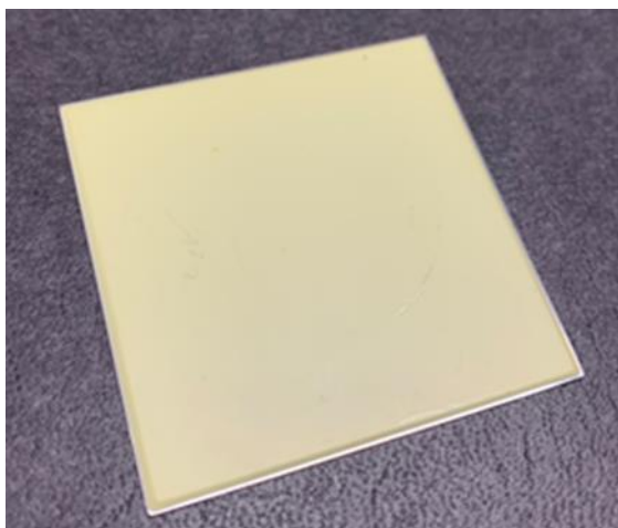
図 1 CsI シンチレータプレート 縦 50 mm, 横 50 mm, 厚さ 0.5 mm
