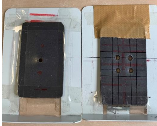
図5 ピンホールコリメータとマルチピンホールコリメータ 直径 3 mm、マルチピンホールの穴と穴の間隔は 1 cm で作成した。
