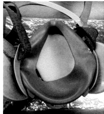
④接顔体変形、しめひも劣化
