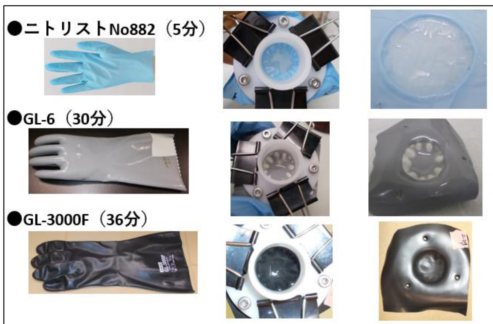
図 42 目視上劣化が確認できた手袋 (写真)
