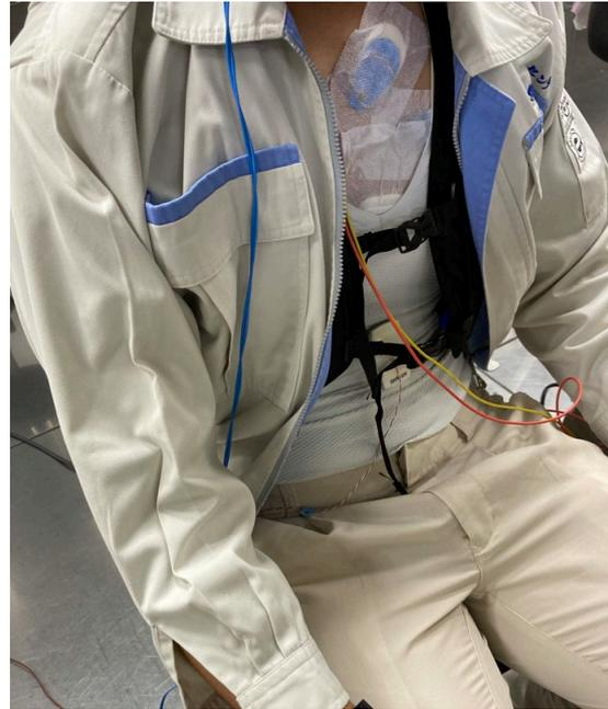
写真2 作業着の内側に水冷ベスト着用
