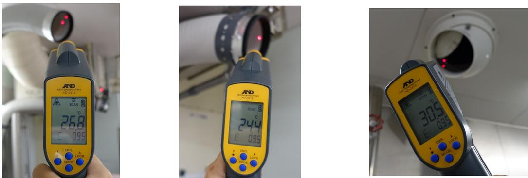
図4 スポットクーラー吹き出し口付近の表面温度測定の様子
