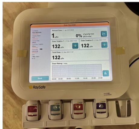
図 3 リアルタイム半導体線量計 (RaySafe i3)
