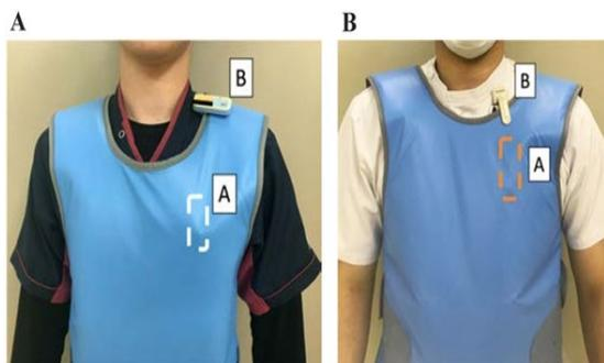
図 1 (A) 線量計はリードエプロンの下 (A、白点線) と上 (B、ガラスバッジ) に 1 つずつ設置することにした。(B) 個人線量計を装着していない人には、電子式個人線量計 (EPD) (PDM-127B-SZ、日立、東京、日本) 2 台をリードエプロンの下 (A、オレンジ点線) および上 (B、EPD) に配置した。
