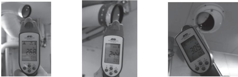
図 6-3 スポットブLOWER吹き出し口付近の表面温度測定
