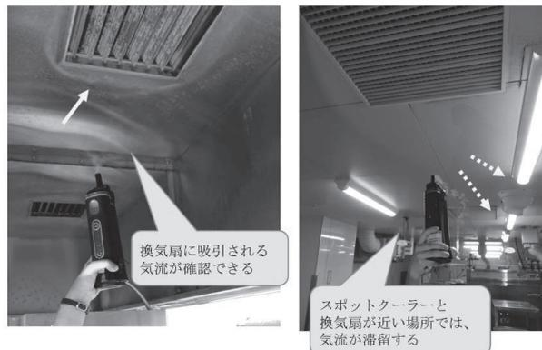
図 6-2 換気扇付近の気流測定
