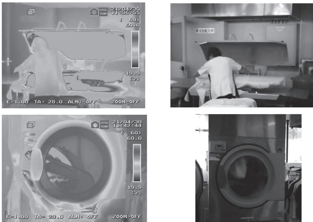
図 5 赤外線サーモグラフィカメラによる表面温度測定
