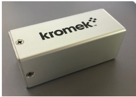
図 2 散乱線スペクトル測定に用いた半導体線量計 (GR-1, kromek, UK)
