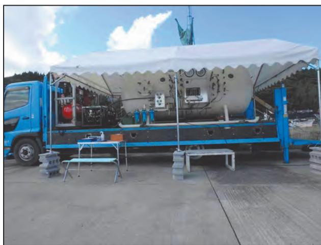
岸壁に設置した再圧室
