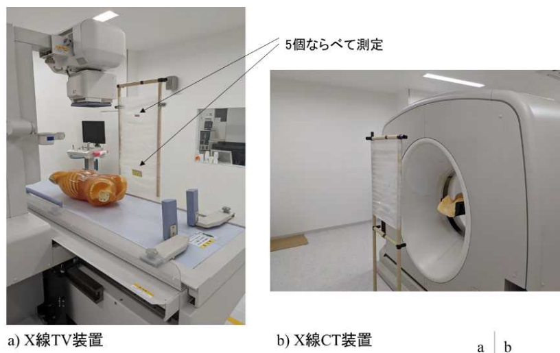
Fig. 3 変動係数測定線の量計配置概観
