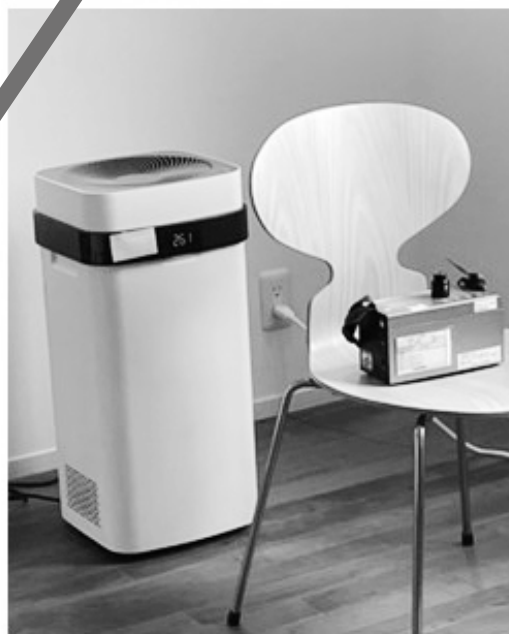
図6 実験ハウス内での換気実証試験—CO 2 および粉塵のリアルタイムモニタリング
