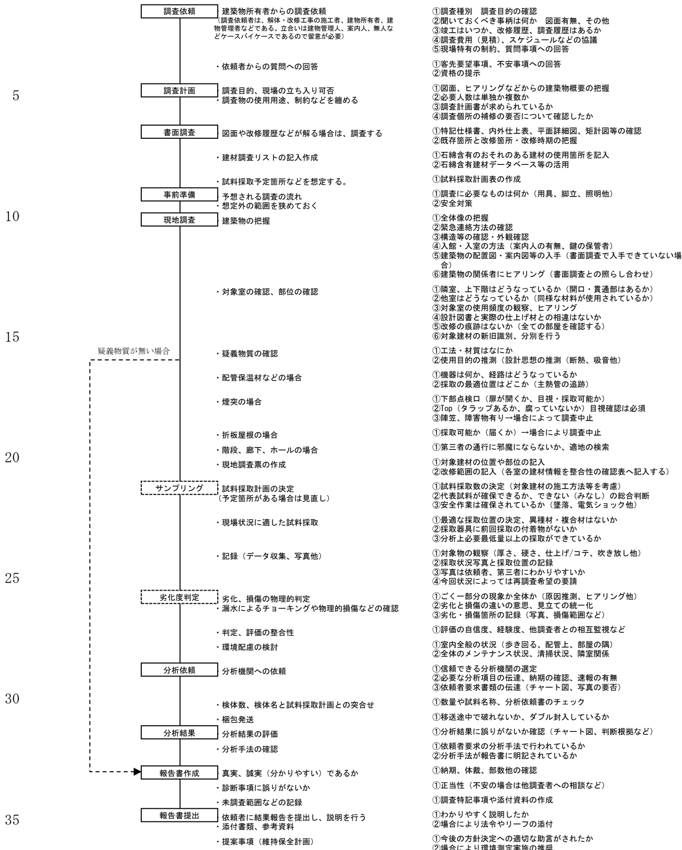
図 3.1 石綿含有建材調査者の業務フロー図と主な視点
