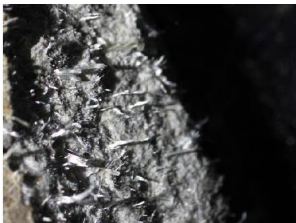
写真1:スレート板中のクリソタイル
