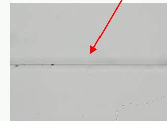
アナライザを抜いた後の基準へき開線の拡大像(写真)
