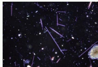
分散法(アモサイト) 試料で生ずる屈折率の分 散で色のコントラストを作 る。
