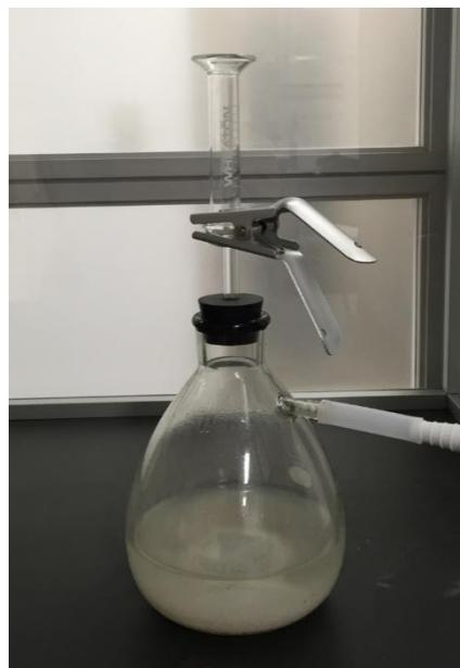
写真 6.3 吸引ろ過装置 ( $\phi 25\text{mm}$ )
