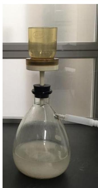
写真 6.4 吸引ろ過装置 ( $\phi 47\text{mm}$ )
