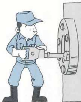
インパクトレンチによる作業
