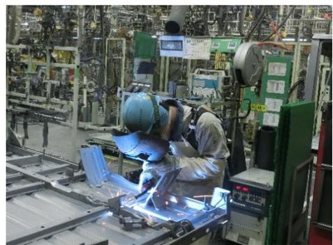
H3 作業者:スポット溶接および CO<sub>2</sub>溶接
