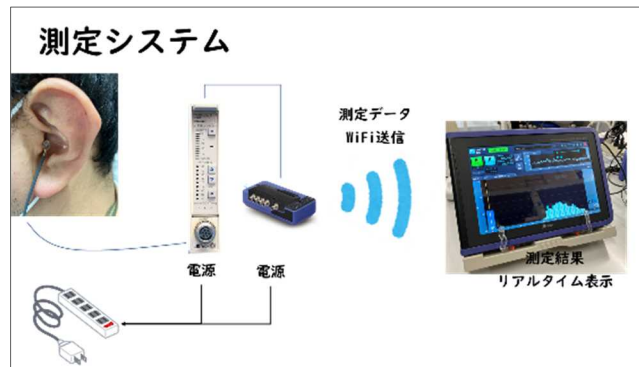
図 5-3 耳孔マイクを用いた電話オペレーターのばく露レベルの測定
