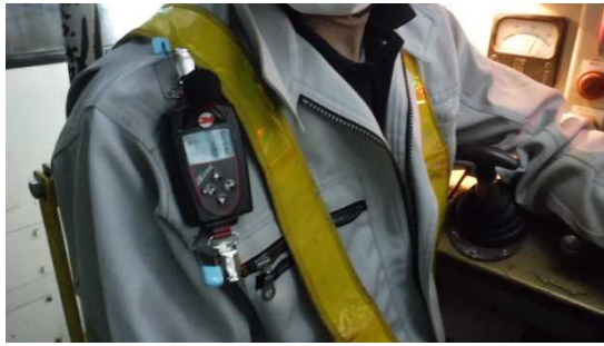
写真 軌道運転作業者 Edge5 装着状況（運転席） 写真 軌道車運転席 NL-62 設置状況
