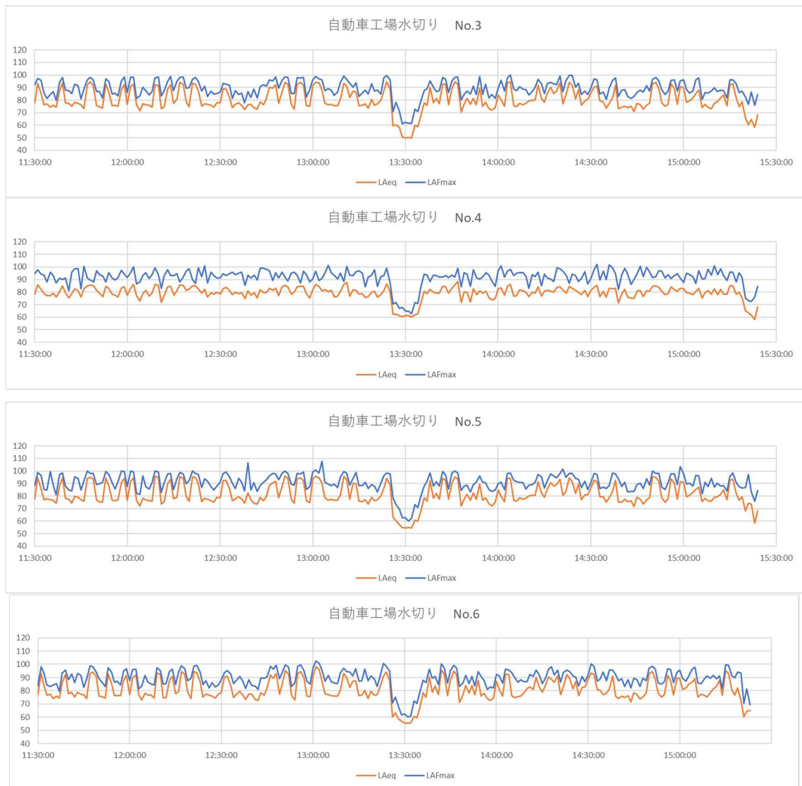
図 1-2 測定点ごとの騒音レベル（エアーガンによる水切り作業）
