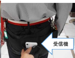
写真：個人ばく露騒音計と受信機 パチンコ台設置風景 (小型ばく露計は露出させず胸ポケットに入れて調査した)
