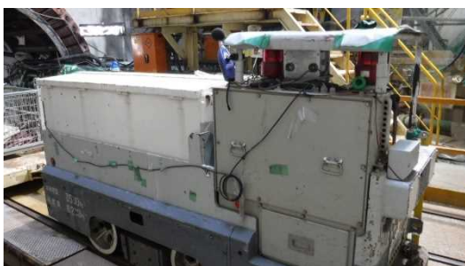
写真：軌道車及び運転席付近に設置した騒音計
