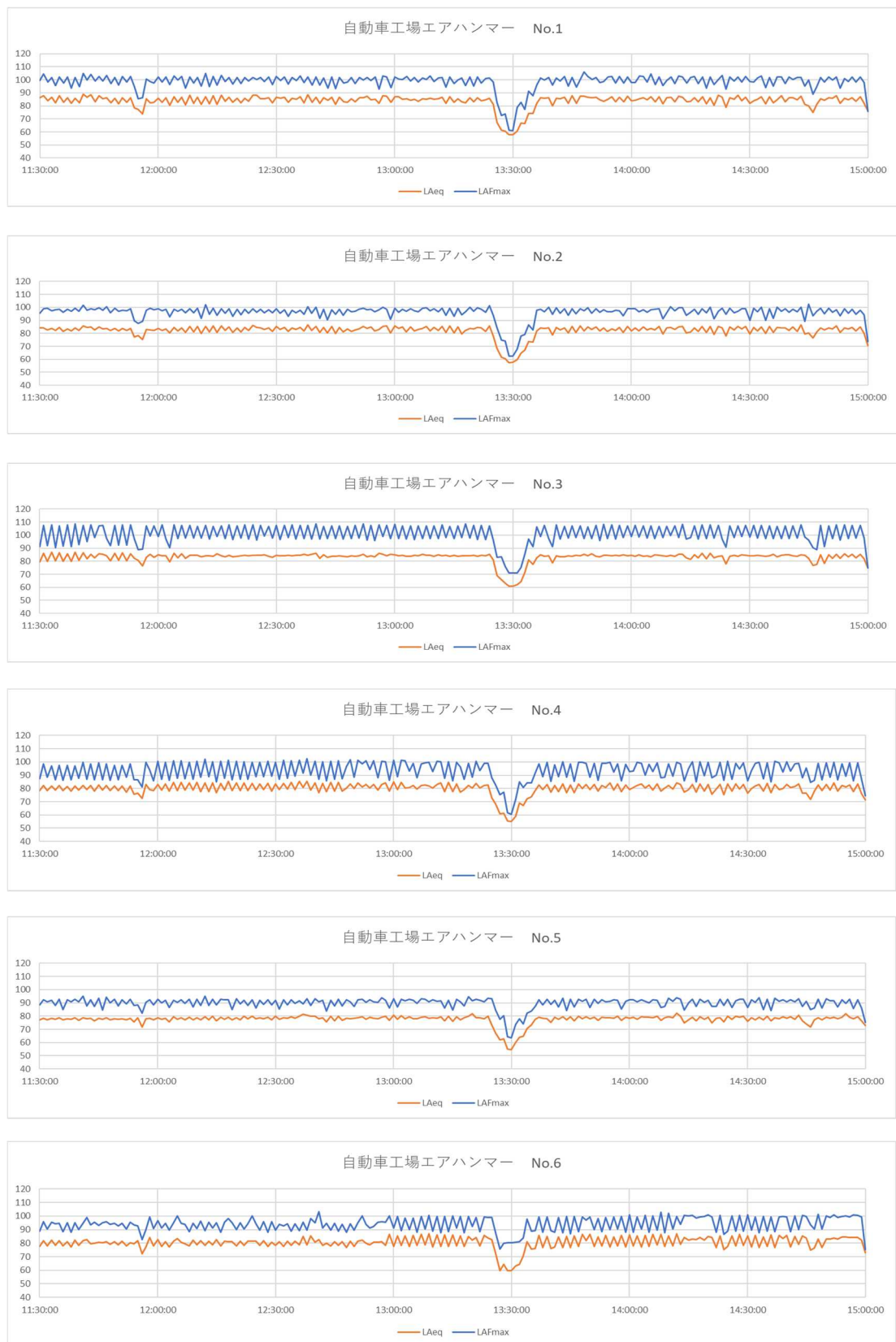
図 2-2 測定点ごとの騒音レベル（手持ち動力工具による作業）
