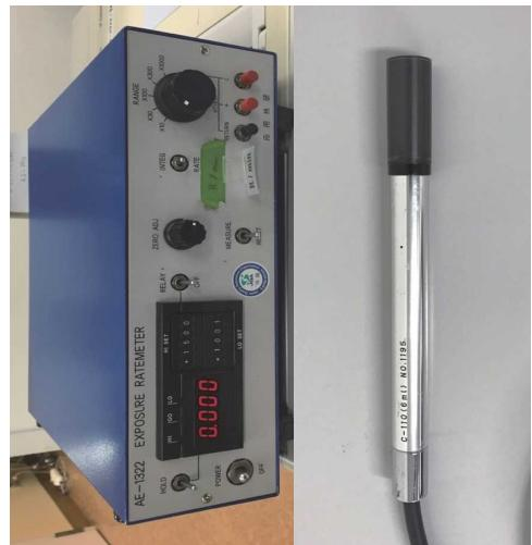
図3-9 電離管線量計、応用技研 電位計：AE-1322、電離箱：C-110(6.0ml)。
