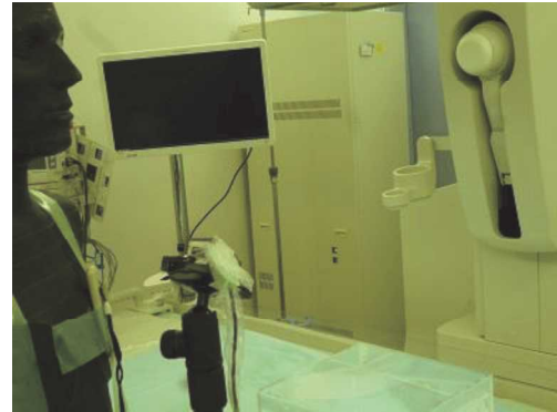
図 6-2 X 線透視装置における術者の胸部位置での散乱 X 線成分の測定の様子
