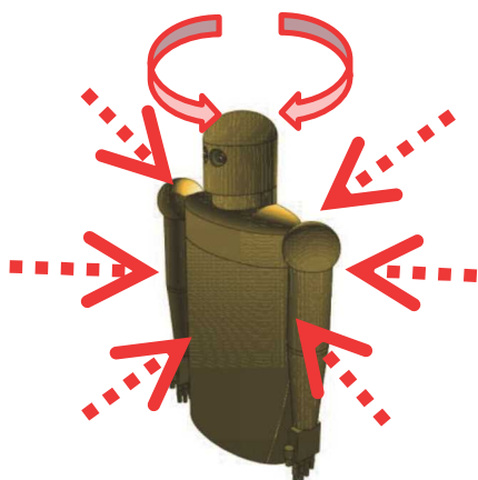
図3 回転照射ジオメトリ (ROT geometry)の模式図
