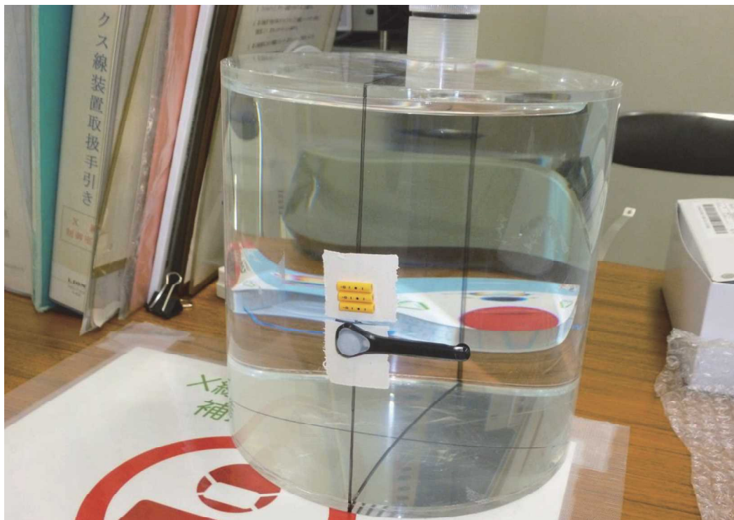
図 1 本研究班で使用するガラス線量計 GD352M 及び水晶体被ばく線量測定用 TLD 線量計 (DOSIRIS) を ISO シリンダーファントムに取り付けた様子。
