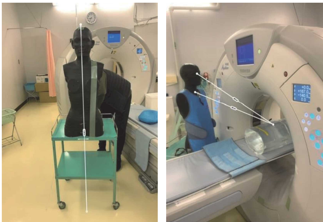
図5 ガラス線量計読み値に対する校正定数ベンチマーク試験に使用した RANDO ファントムと CT 介助者位置でのばく露の様子。
