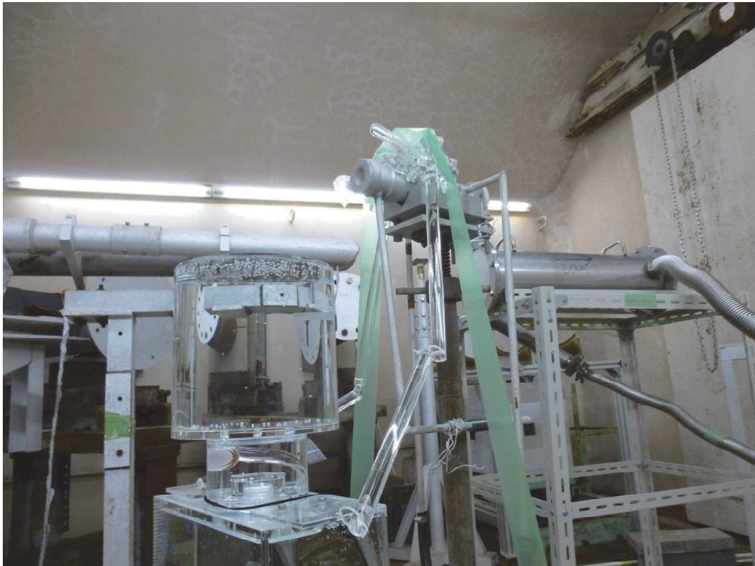
図4 京都大学複合原子力研究所ライナック施設におけるフィールド試験の様子 (ビームコンバーター交換作業を模擬)
