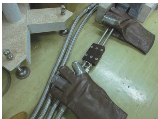
図5 京都大学複合原子力研究所ライナック施設での Ta ターゲットハンドリング作業における防護手袋による線量低減効果の検証
