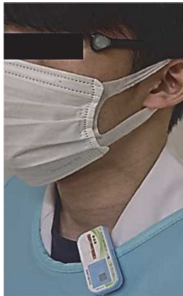
Fig.2 ポータブル撮影での放射線技師の線量計装着位置の概観（左眼に DOSIRIS、左頸部プロテクタ外側にガラスバッジ）
