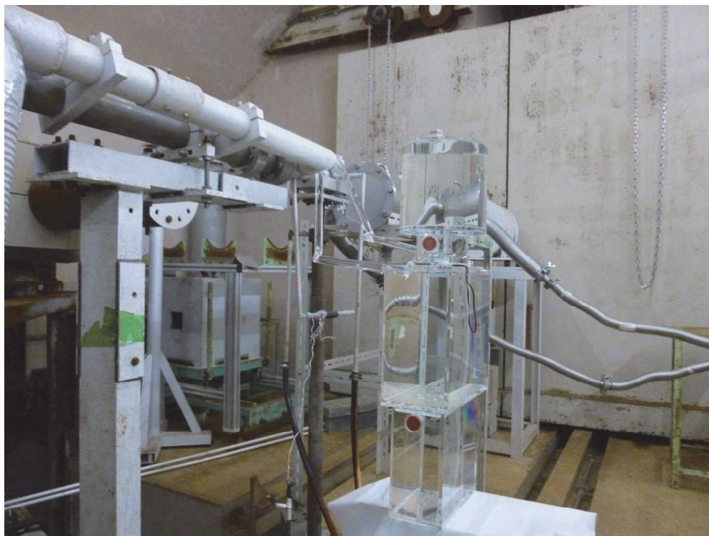
図 2 京都大学複合原子力研究所ライナック施設におけるフィールド試験の様子（簡易物理ファントム各所に OSL 線量計を取り付け、作業環境に設置。ビームコンバーター調整作業を模擬）
