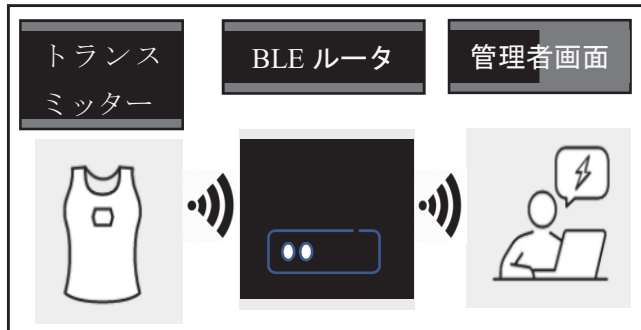
図1 hamon スマホレスシステムの概要(mitsufujiのホームページ 1) の図を参考)
