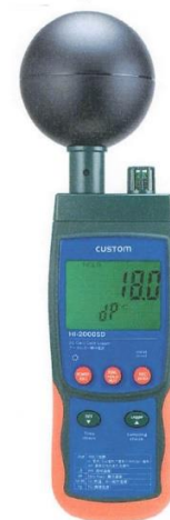
図 8 データロガー熱中症指数計の外観 （引用：カスタム株式会社ホームページより）
