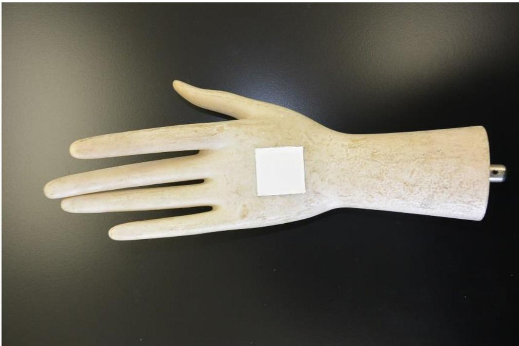
図 1-1-6 手モデル表面へ貼り付けたシート状サンプラー
