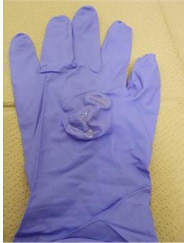
図 2-4-3 ニトリル手袋にオルトトルイジンを付着させたときの外観
