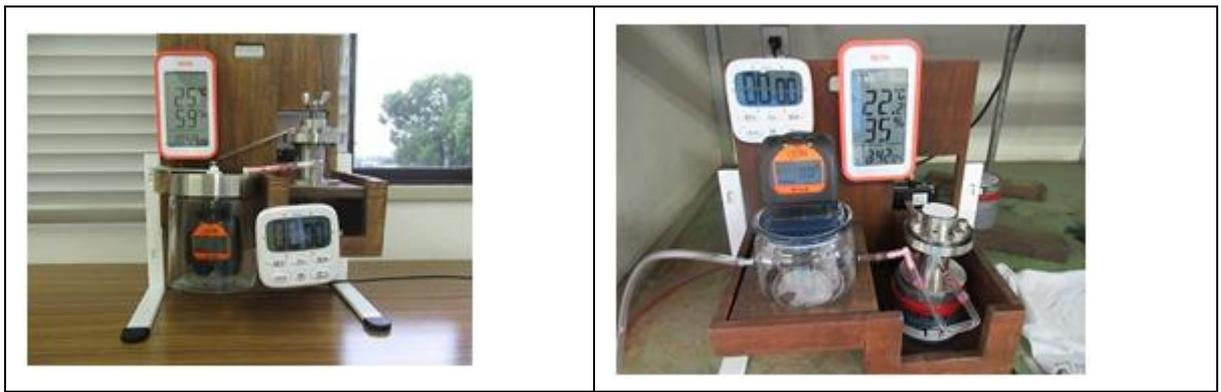
図 3-1-3 循環系測定回路及び開放系測定回路の測定装置
